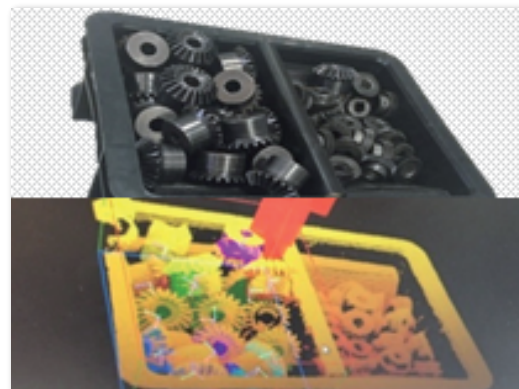
バラ積み状態で正しく認識します
