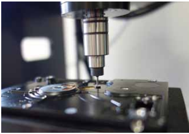
2.5' HDDケース M1.6×0.35 検査例
