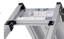
伸縮操作バー 真ん中を引上げれば2脚、 端を引上げれば1脚伸縮できます
