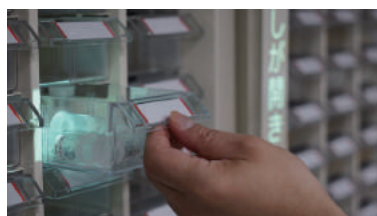
光ったところからピッキング
