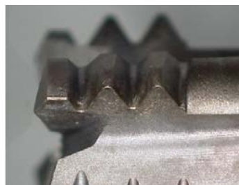
エポックDスレッドミル 50穴加工後の工具状態 Epoch D Thread Mill after threading 50 holes.
