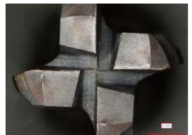
エポックDスレッドミル 50穴加工後の工具状態 Epoch D Thread Mill after threading 50 holes.
