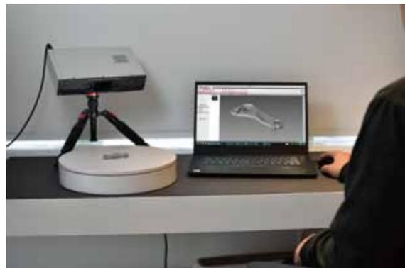
360°回転するターンテーブルを使用することで、ワークを手動で動かすことなく、ワーク全周のスキャンデータを自動で取得できます。回転角度は、ショット数に応じて分割されるため、スキャンする対象の形状の特徴などに合わせて手間をかけずにスキャンをすることが可能です。
