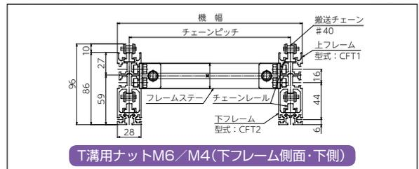
T溝用ナットM6/M4(下フレーム側面・下側)
