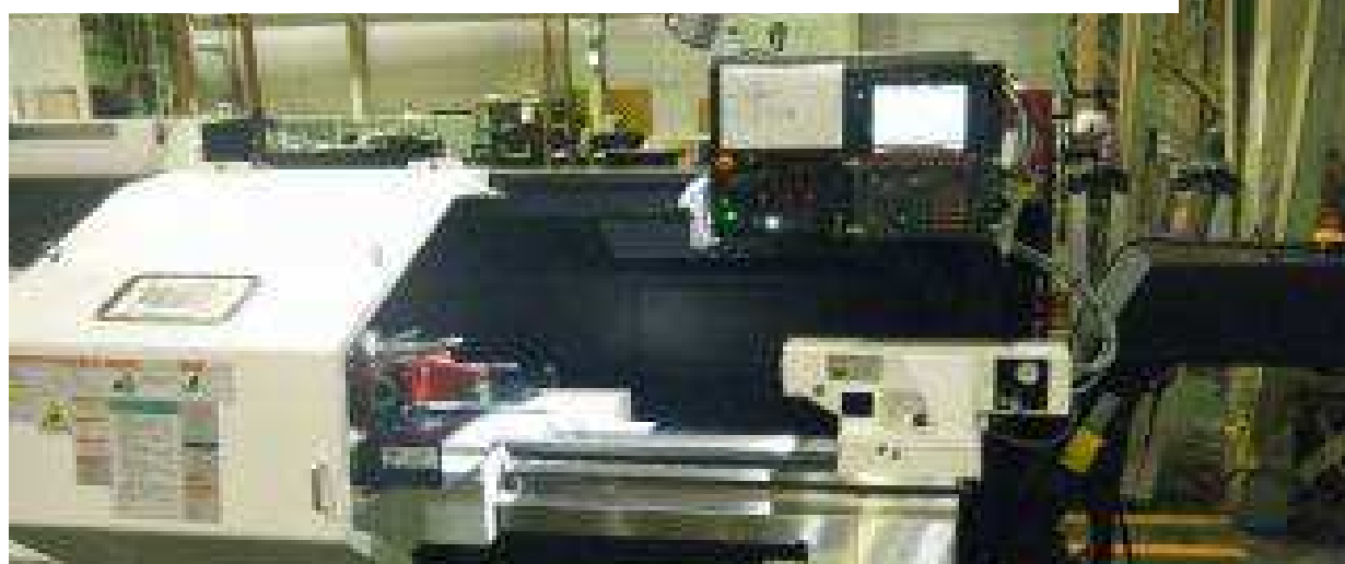
M4 1500U S/N 110775 1994年製 SmoothC 2200min-1 4QC/8B ツールアイ チップコンベア 完成 7月上旬予定 8/18納期
