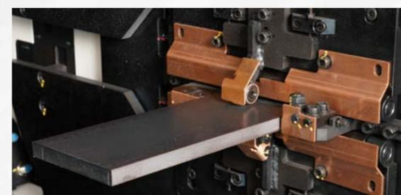
フラットバーに対応する爪を取り付けることで、フラットバーの加工を可能にします。
