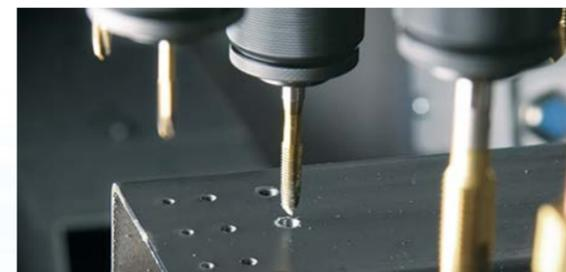
長尺材へのタップ加工も1台で完結。豊富な穴径にも対応し、生産リードタイムを削減でき、生産性向上を実現します。(最大タップ能力:M12)
