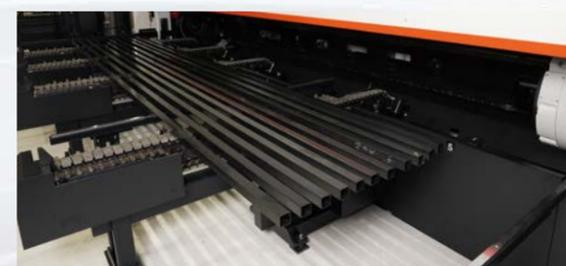
積載本数を大幅に増加でき、サイズごとに、効率よくセットできるため、長時間運転を可能にします。(標準付属品はVサポート式コンベアです)
