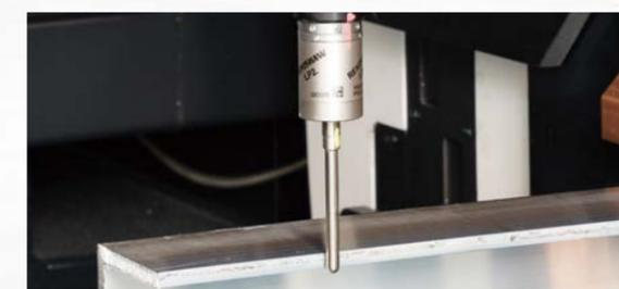
パイプ素材の外形寸法を測定し、素材のゆがみを自動補正。さらに、異形材の加工も可能にします。
