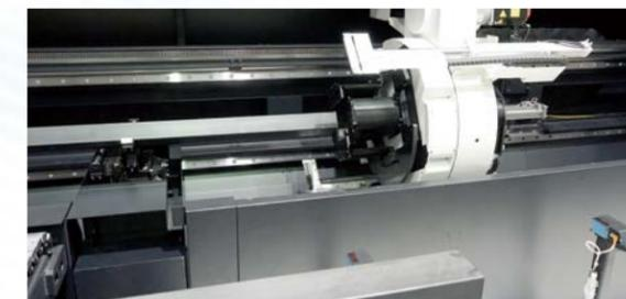
セットした素材の長さを自動的に計測。手作業でその都度計測する手間を省き、確実に素材を保持します。
