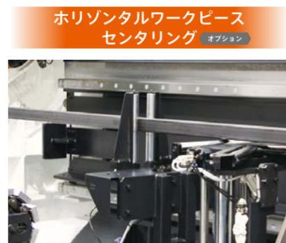
フラットワークピースサポート使用時に、水平方向に変形しやすい長尺の形鋼や小径パイプなどを追従式のローラで支えることで変形を抑えます。
