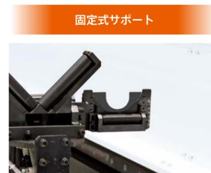
小径パイプの長尺材はV形サポータ横の固定式サポートで支え、自重によるダレを防ぎます。
