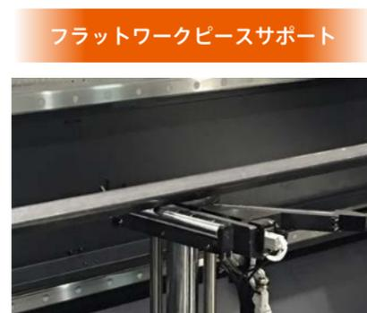
CNC装置で上下動を自動制御するフラットローラで素材を支え、長尺材の自重によるダレを防ぎます。
