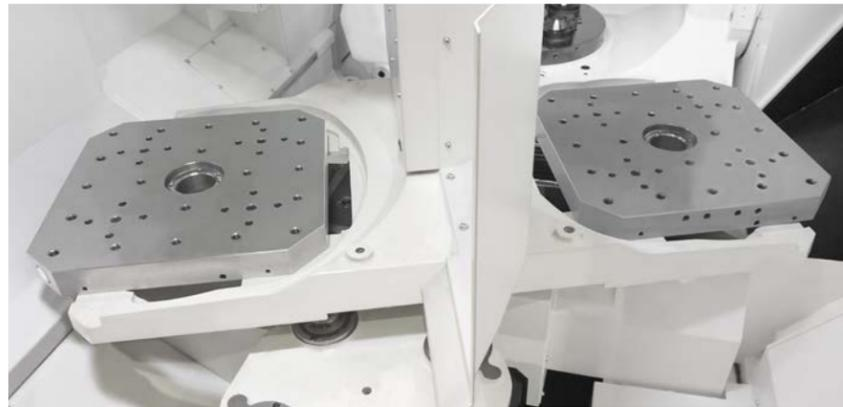
重量ワーク積載のパレットも迅速に交換、加工中に次の加工のためのワーク取付けや段取り作業ができ、生産性が向上します。
