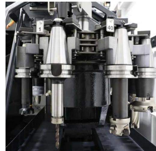
標準で 30 本の工具を収納できるツールマガジンを装備、多品種の部品加工や長時間連続運転の予備工具に対応する 40・80・120 本ツールマガジンをオプション仕様で展開しています。
