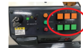
行き先表示盤(オプション) 入力増設ユニット、番地センサ とのセットオプションです。
