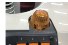
パトライト(無人走行時) 走行時:点滅 アラーム停止中:高速点滅
