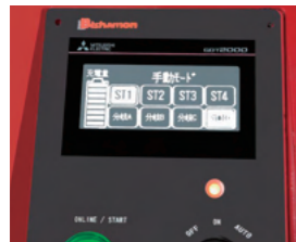
シンプルな操作部 制御はすべて上部の タッチパネルで設定可能
