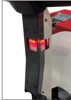
パトライトとメロディーチャイム パトライト点灯パターン ■ 無点灯…電動走行時 ■ 赤色点滅…非常停止中 ■ 黄色点滅…自動走行中 ■ 緑色点滅…センサー検知停止時 交通管制停止時 自動荷おろし時など メロディーの曲数 / 電子音 12種類 メロディー 20曲
