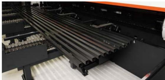
積載本数を大幅に増加でき、サイズごとに、効率よくセットできるため、長時間運転を可能にします。(最大積載本数例: φ20 mm × 40本、φ400 mm × 5本)
