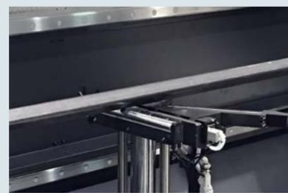
CNC装置で上下動を自動制御するフラットローラで素材を支え、長尺材の自重によるダレを防ぎます。
