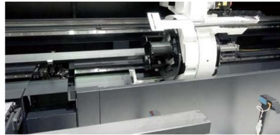
セットした素材の長さを自動で計測。手作業でその都度計測する手間を省き、確実に素材を保持します。
