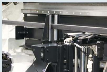
フラットワークピースサポータ使用時に、水平方向に変形しやすい長尺の形鋼や小径パイプなどを追従式のローラで支えることで変形を抑えます。
