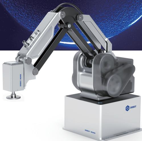
DOBOT MG400 は、超小型デスクトップ式ロボットアームであり、設置に必要な底面積は A4 サイズ以下で OK です。携帯性、設置性、操作性に優れ、安全性が高いなどの特徴により、多目的で小ロットの自動化製造現場のニーズに対応します。最大可搬質量・500g、440mmのアームサイズで、デスクトップ環境での作業に最適です。ダイレクトティーチング、衝突検出機能などのマン・マシン協働機能、そして持ち運びやすく設置しやすいという特徴により、製造ラインの即戦力となります。製造自動化、スマート化を推し進める上でコストパフォーマンスに優れたロボットアームです。
