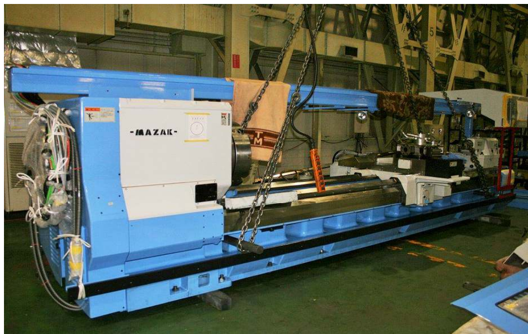
PM4000U レトロフィット機 <After> ※指定色塗装
