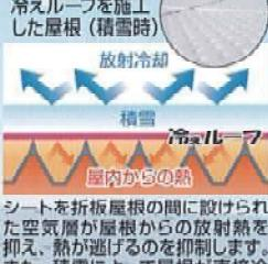
冷えルーフによって屋根からの放射熱が遮られ空気層の熱が逃げにくくなることで、高い保温効果を発揮します。(屋根裏面の結露環境が見られない)
