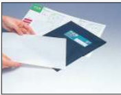
①プレスケール又はプレシートを測定に必要な形に切り取ります。
