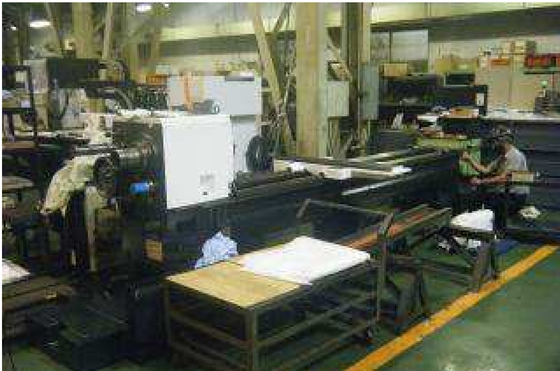
OPEN機 リプレース機 M5 2500U S/N 162365 2003年製 SmoothC 主軸 \Phi 104 2200min-1 8D+6B 完成 9月末予定 (チャックなし) ベッド研磨済
