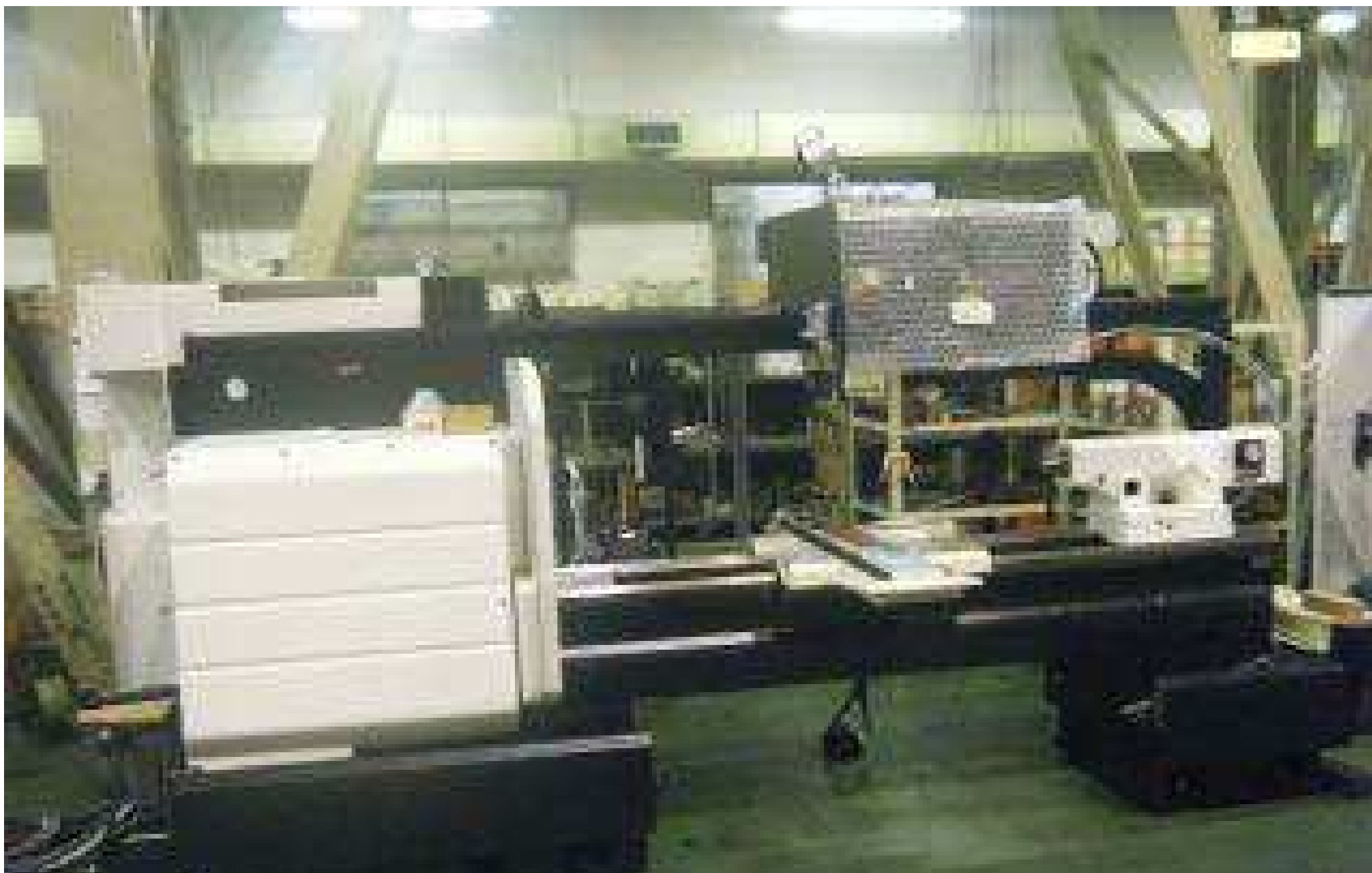
OPEN機 リプレース機 M4 1500U S/N 95957 1990年製 SmoothC 2200min-1 8D+6B 9月末完成予定 ベッド研磨完了
