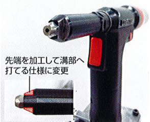
●先端の加工にさらにロングノーズピースを組み合わせた例
