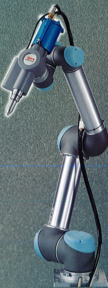
縦型エアリベッター + 協働ロボット
