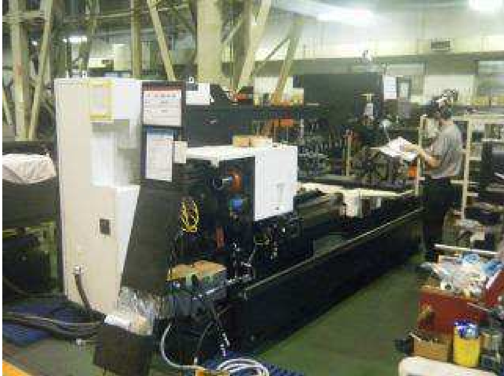
OPEN機 リプレイス機 M4 1500U S/N 95957 1990年製 SmoothC 2200min-1 8D+6B 10月末完成予定（現状チャック無し）
