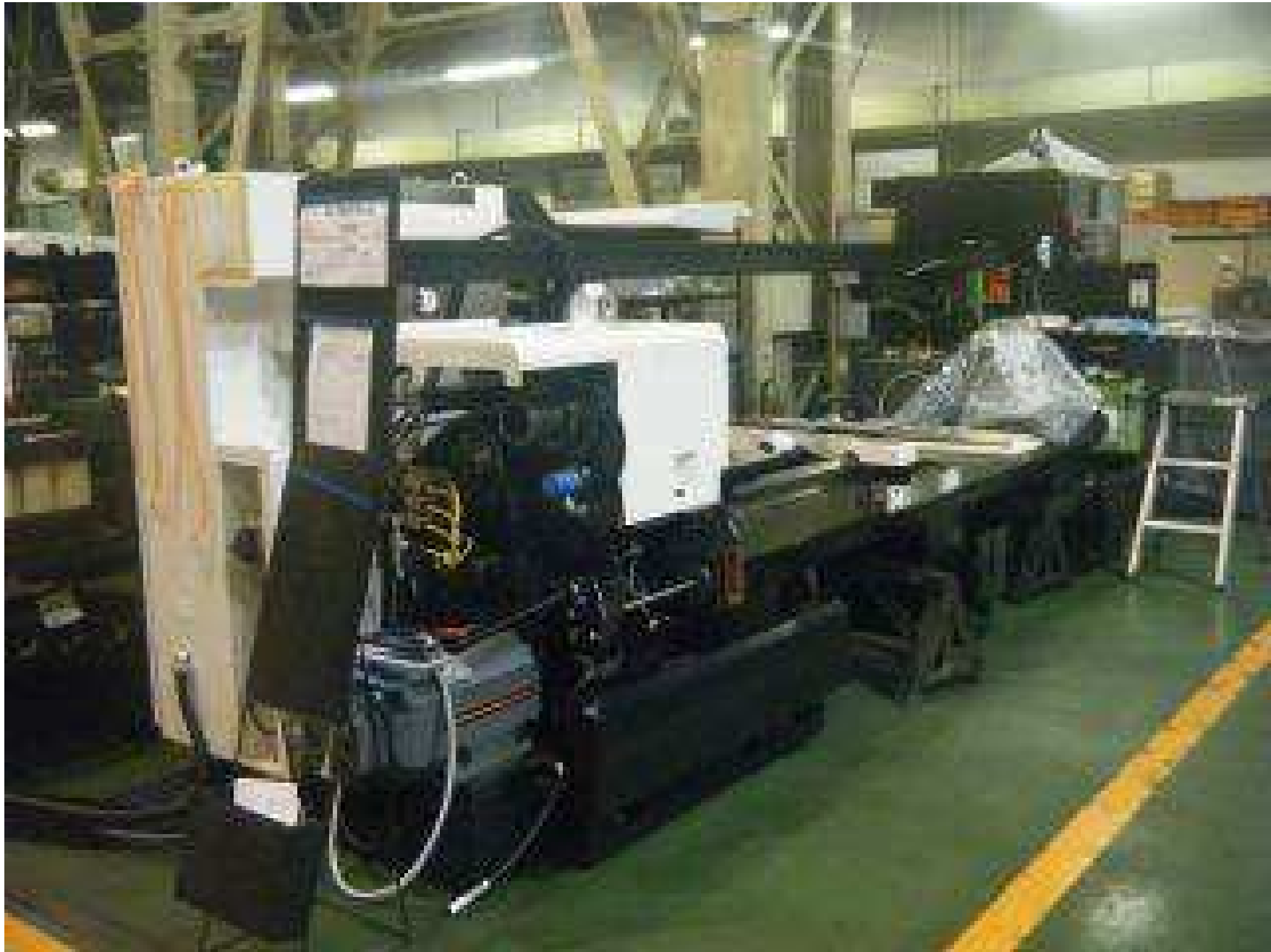
OPEN機 リプレース機 M5 2500U S/N162365 2003年製 SmoothC 主軸 \Phi 104 2200min-1 8D+6B 完成10月末予定 (現状チャック無し)
