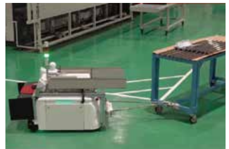
連結台車牽引
