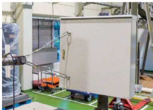
耐風圧性能試験例
