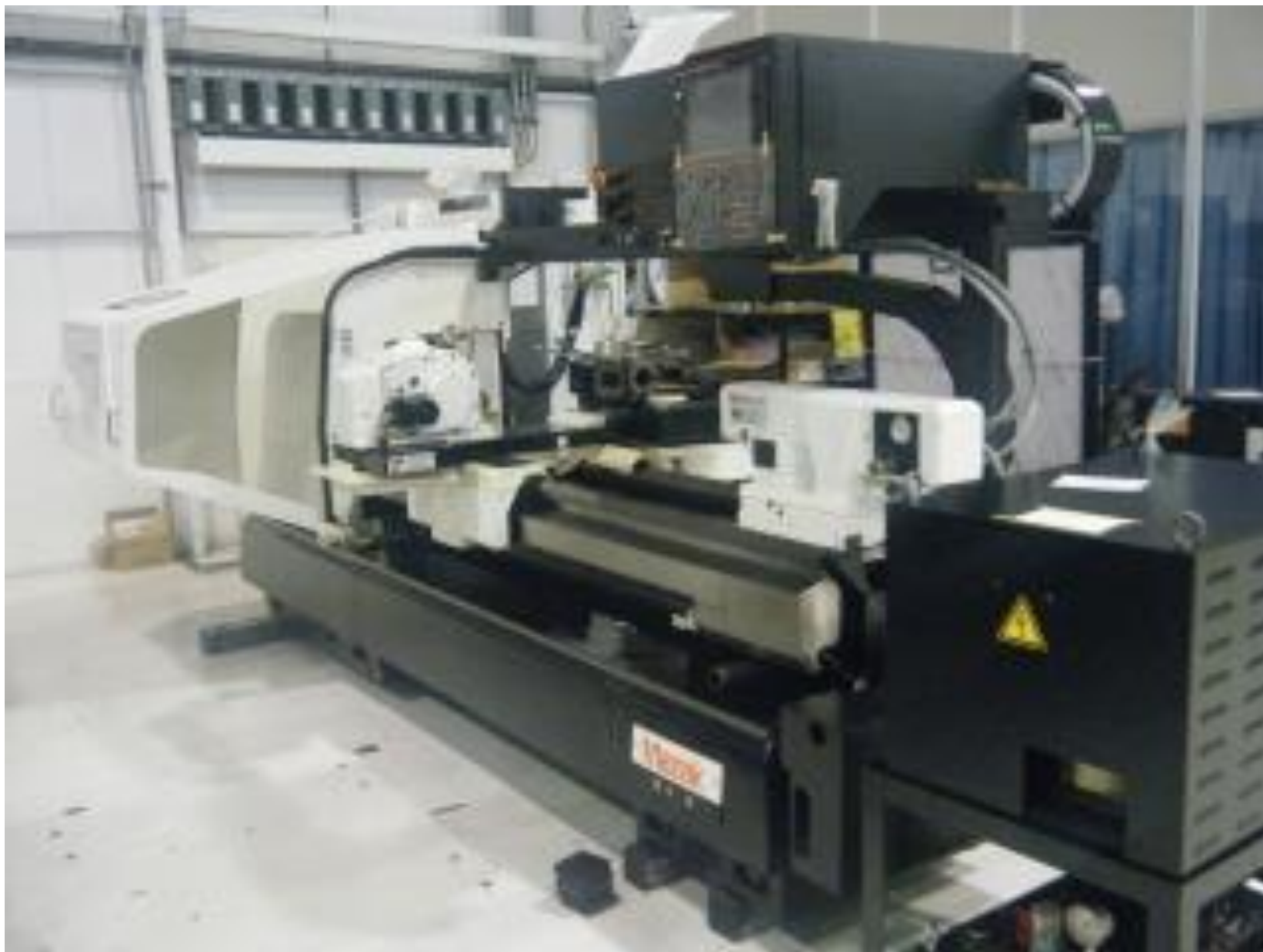
OPEN機 リプレース機 M4 1500U S/N 95957 1990年製 SmoothC 2200min-1 8D+6B (現状チャック無し)
