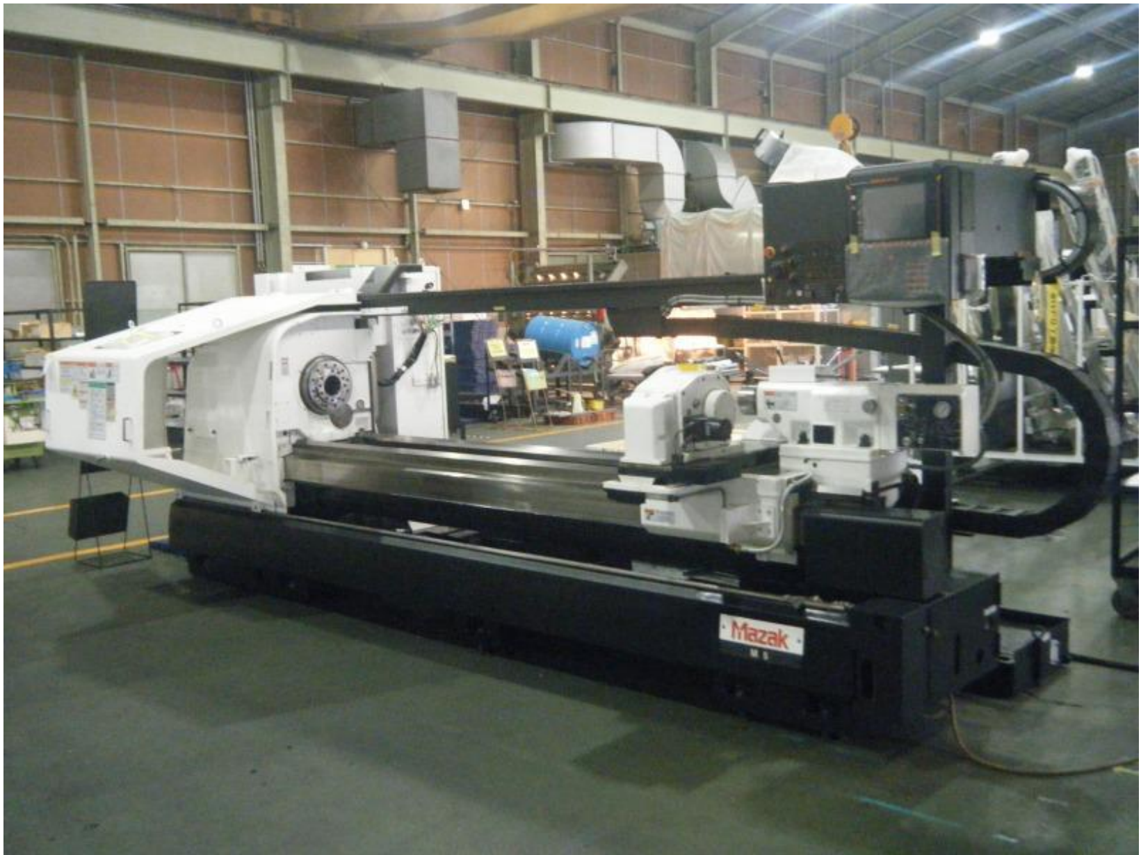
OPEN機 リプレース機 M5 2500U S/N162365 2003年製 SmoothC 主軸Φ104 2200min-1 8D+6B 現状チャック無し
