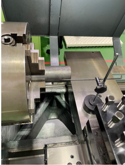
心出し作業の様子
