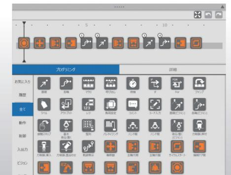
手でロボットを動かしてタイムライン上に専用指令アイコン
