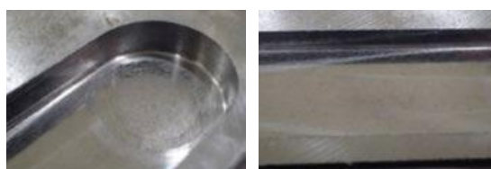
突込み → 横引き Plunging Horizontal Milling
