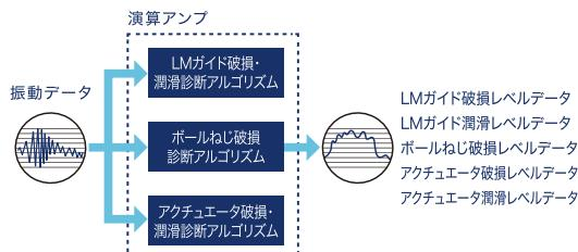
既に現場で稼働している装置の機械要素部品に後付けができるよう、センサの設置も非常に簡単に行うことができます。機械要素部品のトップメーカーとして蓄積してきたデータから、独自のアルゴリズムを開発。部品の状態を見える化できるので、"いつもとちがう"を知ることができます。
