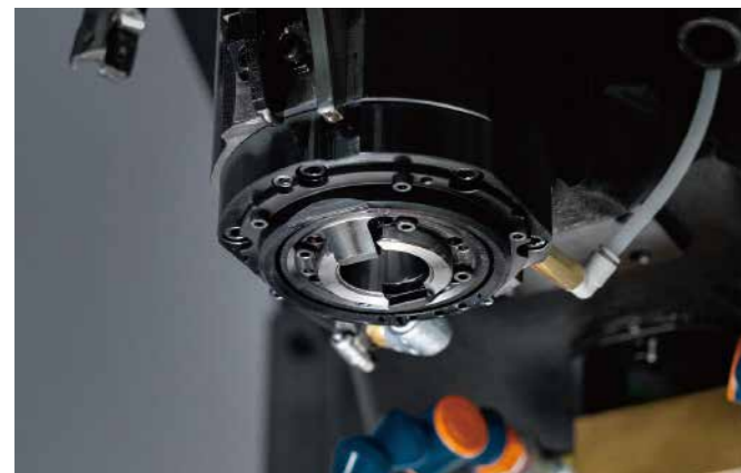
主軸起動/停止時間 0.2s以下
