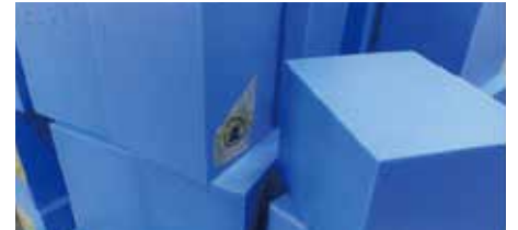
↑ 外箱に使用されるCast Nylon素材。高い絶縁性、耐久性を誇ります。
