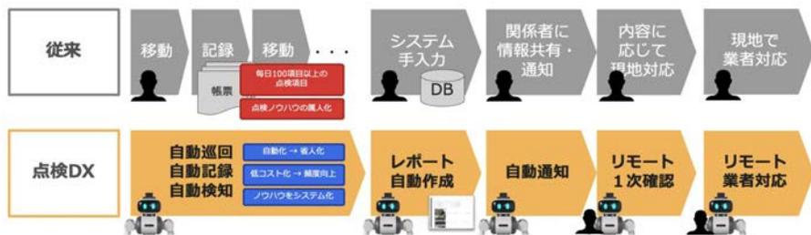
ugo miniを使うと、施設内の点検ポイントに自動で移動し、4Kカメラや各種センサーを活用して自動で記録していきます。更にはレポート作成から点検結果の通知まで自動化が可能です。また、異常時の一次切り分けは管理者がリモート対応も可能です。
