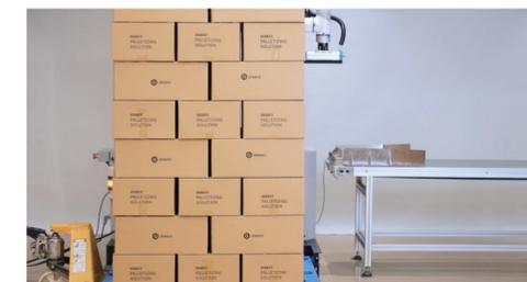
3. パレット積載が完了しました。インジケータライトは黄色に点滅します。
