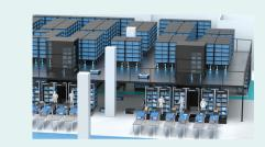
当社従来方式に比べ1.5倍※2の商品保管面積を 実現。デッドスペースになりがちな倉庫上部の 空間を有効活用し、自動搬送ロボットと保管棚 により収容力を拡大します。
