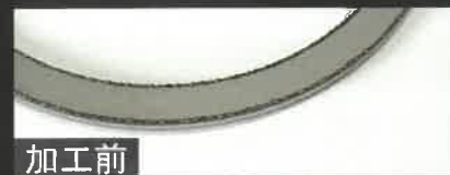
SS 材 1.6t φ70 mm レーザーカット
