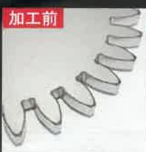
SUS 5.0t \Phi 100 mm レーザーカット
