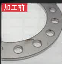
SUS 3.0t \Phi 100 \times \Phi 70 レーザーカット
