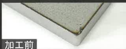
SUS304 8.0t 35×35 mm レーザーカット
