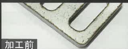
SUS304 2.0t 20×30 mm レーザーカット
